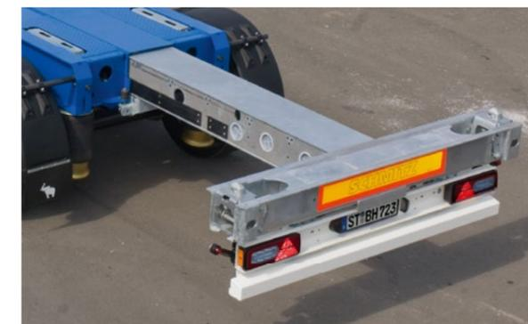
La **extensión trasera** con accionamiento neumático permite seleccionar el posicionamiento del container.
