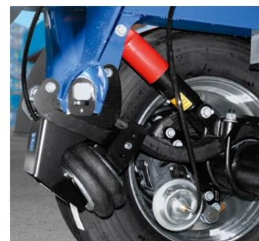
El **eje elevable\*** con ayuda de arranque aumenta la batalla y refuerza con ello las presiones sobre el eje motriz.
