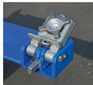
Enganche doble: como **TWIST LOCK** para contenedores de 40' sin túnel o 20' delantero y como **PIN LOCK** para contenedores de 40' con túnel.
