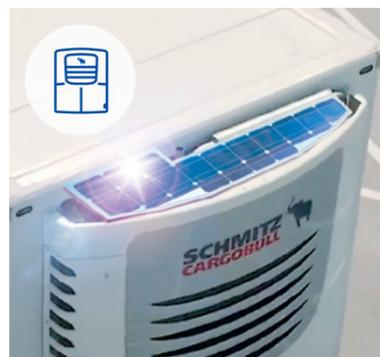
**Solarpanel\*** schützt die Starterbatterie vor Tiefenentladung und somit vor Beschädigung. Die Batteriebensdauer wird erhöht und Komfortfunktionen sind länger verfügbar.
