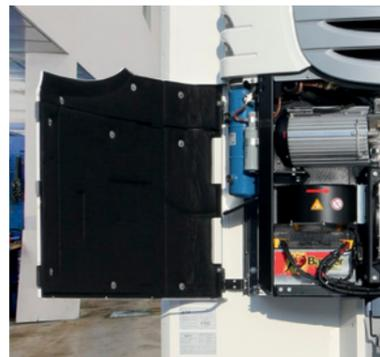
**Silent-Kit** ist in der Verkleidung jeder Kältemaschine S.CU serienmäßig verbaut und reduziert die Antriebsgeräusche.
