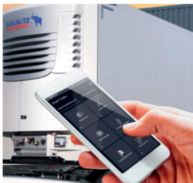
**Zwei-Wege-Kommunikation\***: Bedienerfreundliche Steuerung over-the-Air via TrailerConnect® Portal und App.: z. B. Ein- / Ausschalten, Start- / Stopp-Modus, Setpoints setzen, CargoSets einstellen.
