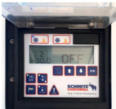
**Das Bedienpanel** besitzt eine intuitive Menüführung. 17 Landessprachen sind einstellbar. Das Bedienpanel ist gegen unbefugten Eingriff PIN-gesichert
